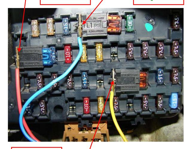
Ziehen Sie die Sicherung Nr.: 85>7,5A und setzen diese in den Sicherungsadapter mit dem gelben Kabel
