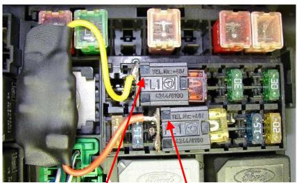
Setzen Sie den Sicherungsadapter mit dem gelben Kabel in den freigewordenen Sicherungsplatz 7,5A, so dass die Sicherung wie im Bild nach **rechts**  Setzen Sie den Sicherungsadapter mit dem roten Kabel in den freigewordenen Sicherungsplatz 20A, so dass die Sicherung wie im Bild nach **rechts** zeigt
