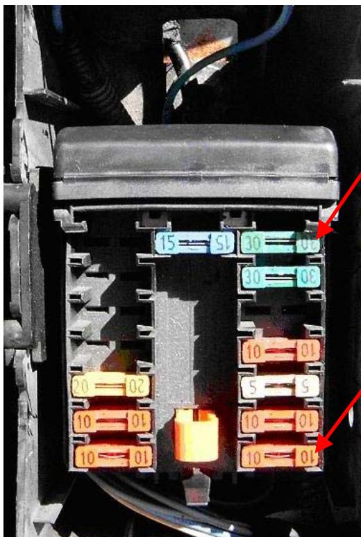
Setzen Sie den Sicherungsadapter mit dem roten Kabel in den freigewordenen Sicherungsplatz Nr.: 3 > 30A so dass die Sicherung im Bild nach **unten** zeigt
