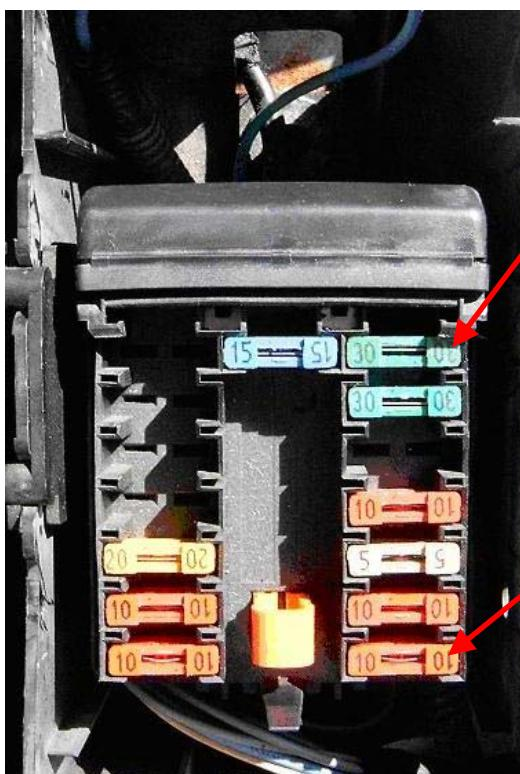
Ziehen Sie die Sicherung Nr.: 3 > 30A und setzen diese in den Sicherungsadapter mit dem roten Kabel
