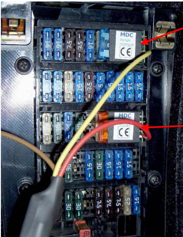
Ziehen Sie die blaue Sicherung Nr.: A10 > 15A aus der Fassung und setzen diese in den Sicherungsadapter mit dem **gelben** Kabel
