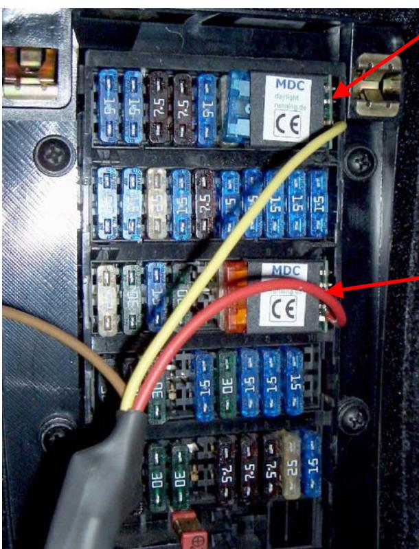
Setzen Sie den Sicherungsadapter mit dem **gelben** Kabel in den nun freigewordenen Sicherungsplatz Nr.: A10, so dass die Sicherung nach **links** zeigt
