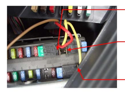
Ziehen Sie die Sicherung Nr. 18 und stecken Sie sie in den Halter mit dem roten Kabel. Anschliessend stecken Sie den Halter so ein, dass die Sicherung nach links zeigt.
