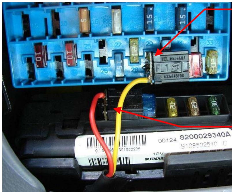
Setzen Sie den Sicherungsadapter mit dem gelben Kabel in den freigewordenen Sicherungsplatz Nr. 29 der 10A Sicherung, so dass die Sicherung nach **rechts**
