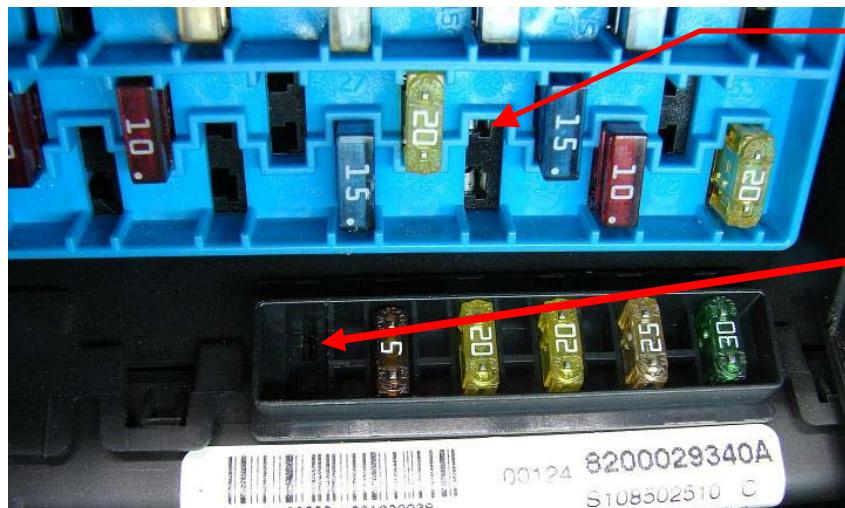
Ziehen Sie die rote Sicherung Nr. 29> 10A und setzen diese in den Sicherungsadapter mit dem gelben Kabel, ziehen ebenfalls die blaue Sicherung 15A und setzen diese in den Sicherungsadapter mit dem roten Kabel
