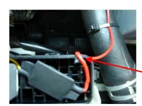
An dieser Stelle etwas Kunststoff entfernen, um das Kabel herauszuführen
