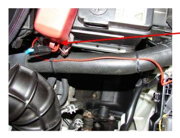
Die Schrauböse mit dem Sicherungshalter hier am Pluspol der Batterie anschrauben
