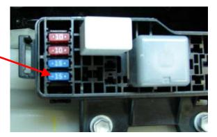
Verlegen Sie das Kabel mit dem Modul im Sicherungskasten
