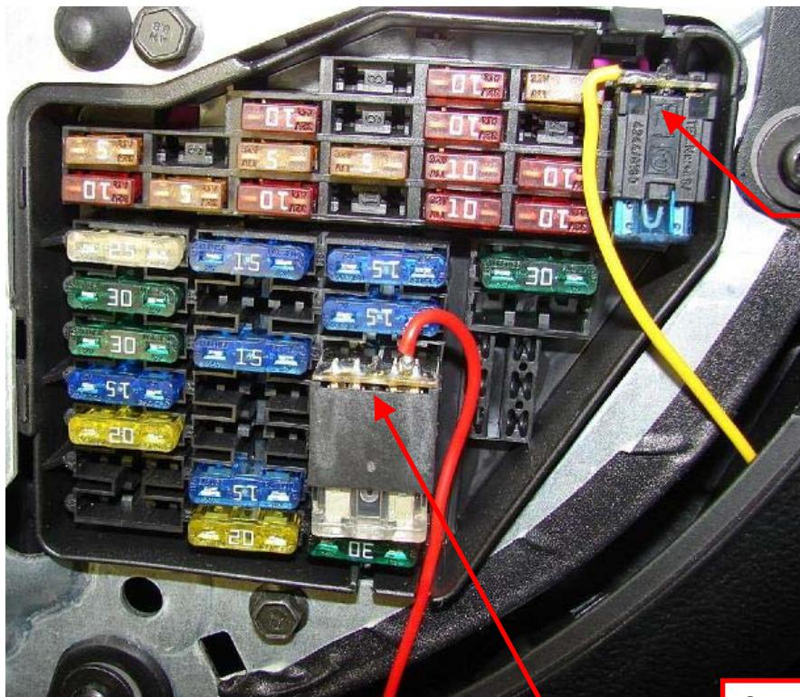
Setzen Sie den Sicherungsadapter mit dem gelben Kabel in den freigewordenen Sicherungsplatz Nr.: 20, so dass die Sicherung nach unten zeigt
