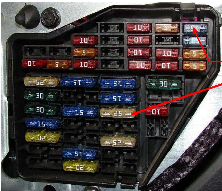
Ziehen Sie die Sicherung Nr.: 20 > 15A und Nr.: 40 > 25A aus der Fassung und setzen diese in die beiden, mitgelieferten Sicherungsadapter
