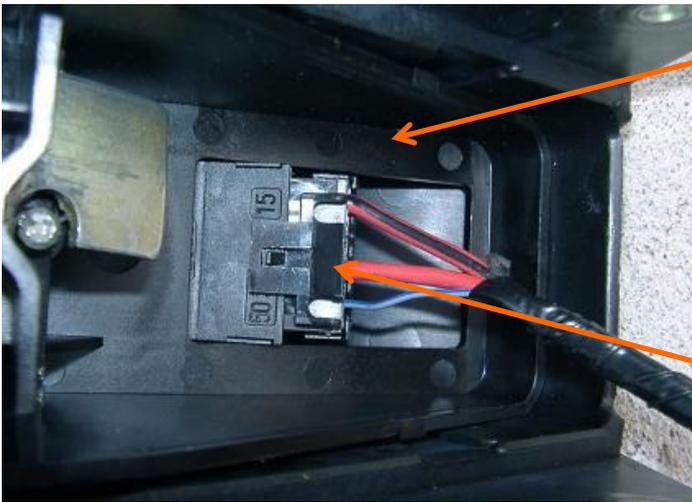
Die Schalthebelbox vom Tunnel heben und den Zündkabelstecker abziehen
