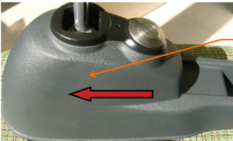
Nun die Tunnelabdeckung in Fahrtrichtung schieben und entfernen
