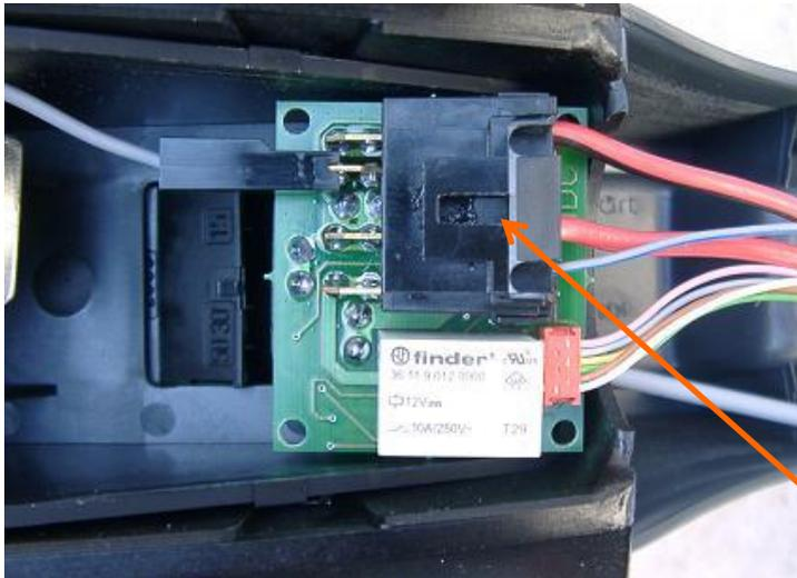
Die Steuerplatte so in den Hohlraum setzen und den Startstecker auf die Kontakte schieben
