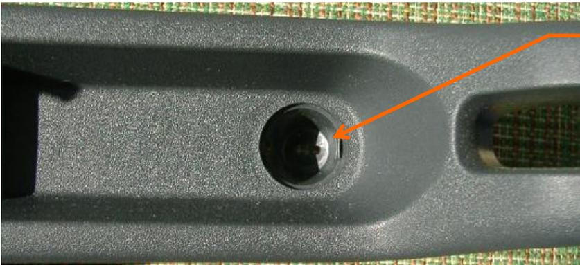
Ziehen Sie den Verschlussstopfen nach oben heraus und entfernen die darunter liegende Torx 20 Schraube.
