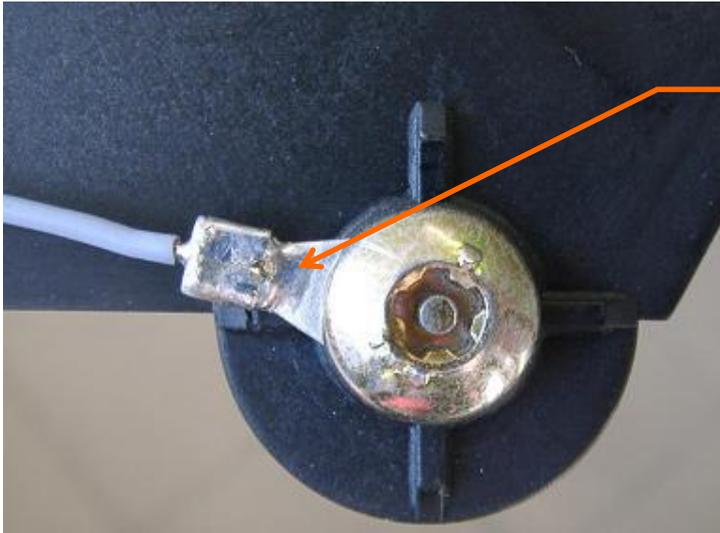
Das graue bzw. braune Massekabel wird mit dieser Lochöse unter eine der Schaltboxbefestigungsschrauben geleitet.
